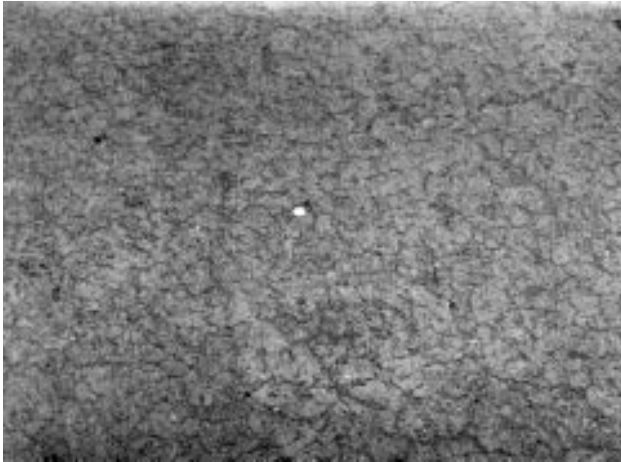
Х2.41-р зураг - Эвдрэлийн түвшин багатай торлосон холбоост хагарал ба хялгасан хагарал
