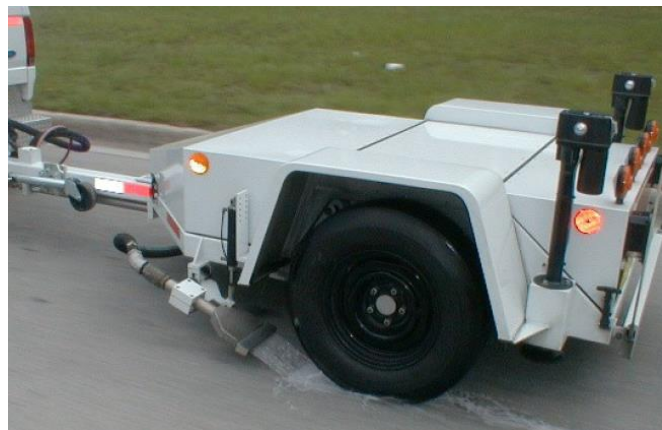
25-р зураг- Туршилтын тэргэнцэрээр хэмжилт хийж байгаа нь
