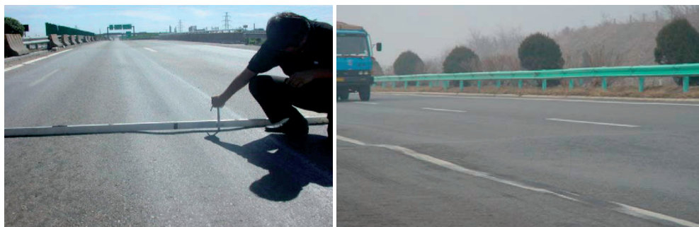
а. Дугуйн мөрөөрх хотойлтын хэмжилт б. Тэгш бус байдал
