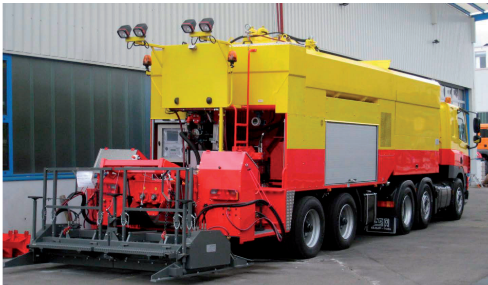
Зураг 4.5-Слари сийлийн /эмульс-минералын цутгамал хольцын/ машин
