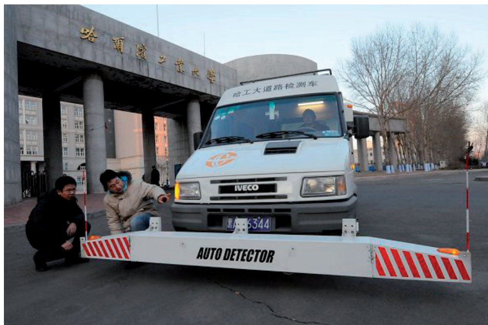
Зураг 2.11- Хөндлөнгийн тэгш байдал /дугуйн мөрний хотойлтын гүн/ хэмжигч төхөөрөмж
