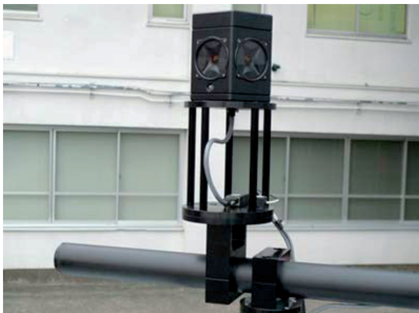
Зураг 2.18- Арааман (тогтоогч хүрэн) дээр байршуулсан SGB IG-20A Инклинометр бүхий Ladybug3 маркийн дээд камер
