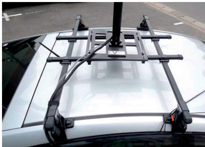
Зураг 2.19- Хийцийн суурь хүрээ бэхлэх, машины ачаа
