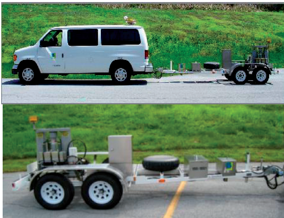
Зураг 2.35- Тэргэнцэр дээр суурилуулсан “динамик ачааллаар хучилтын хotoйлт /FWT/ тодорхойлогч ” багаж
