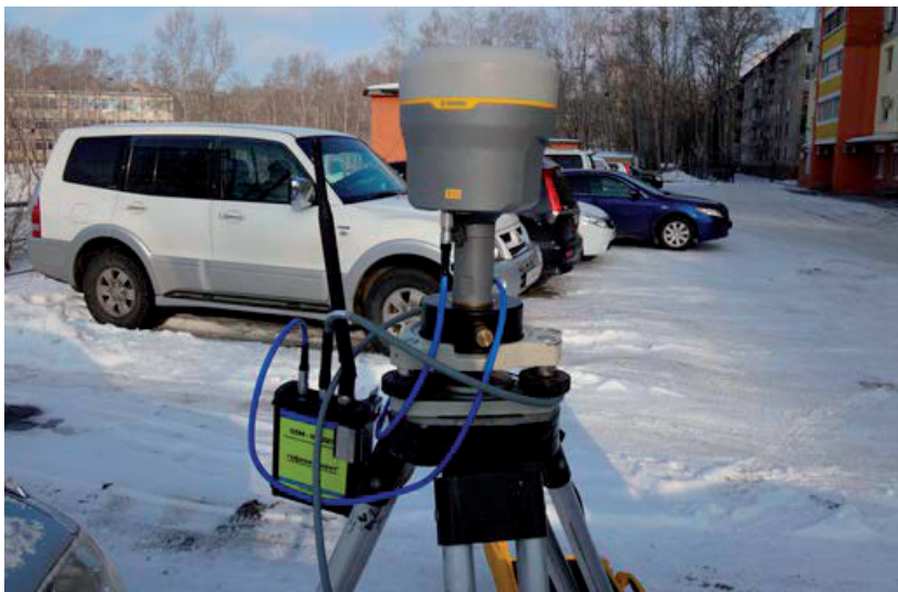
Зураг 2.22-ХДЧС-ийн модем болон Trimble R10 суурь бааз бүхий хүлээн авагч
